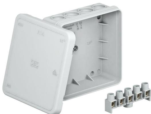
Schutzart IP55, Nennspannung 690 V, Nennquerschnitt 2,5 mm<sup>2</sup>, 8 Einführungen für Kabeldurchmesser 5-14 mm
