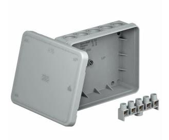
Schutzart IP55, Nennspannung 690 V, Nennquerschnitt 2,5 mm², 10 Einführungen für Kabeldurchmesser 5-14 mm 8 Einführungen für Kabeldurchmesser 5-11 mm. Klemmdeckel.
