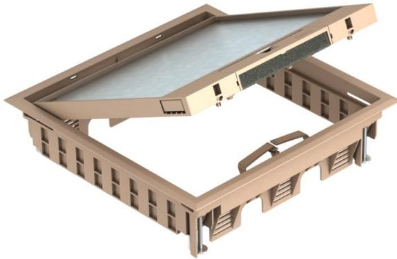
Geräteinsatz mit Griffbügel für bis zu 12 Modul 45-Einzelgeräte in 3 Universalträgern UT4, Einsatz in Kanalsystemen und Systemböden im Innenbereich. Bodenbelagausparung im Klappdeckel voreingestellt auf 5 mm, bei Bedarf auch einstellbar auf 10 mm.
