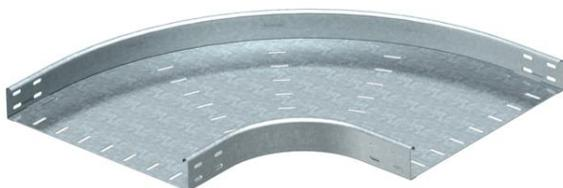
Bogen 90°, horizontal, für alle Kabelrinnentypen mit der Seitenhöhe 60 mm. Formteil in runder Ausführung. Der Innenradius des Formteils beträgt 150 mm. Befestigungsmaterialien sind separat zu bestellen.
