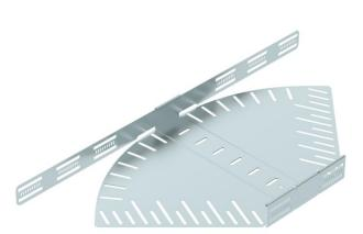
Winkelverstellbarer Bogen zum Erstellen einer horizontalen Abzweigung, Formteil für rast- und schraubbare Kabelrinnen Seitenhöhe 60 mm. Einstellbarer Winkel 0 - 90°. Schraubenlose Montage mit Doppelklemmen oder Schraubverbindung mit Flachrundschrauben FRS und Kombimuttern M6. Einsetzbar im Innenbereich. Befestigungsmaterial muss separat bestellt werden.
