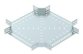
Kreuzung zum Erstellen einer horizontalen Abzweigung, Formteil für rast- und schraubbare Kabelrinnen Seitenhöhe 60 mm. Schraubenlose Montage mit Doppelklemmen oder Schraubverbindung mit Flachrundschrauben FRS und Kombimuttern M6. Einsetzbar im Innenbereich. Befestigungsmaterial muss separat bestellt werden.
