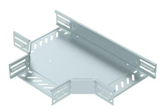
T-Stück zum Erstellen einer horizontalen Abzweigung, Formteil für rast- und schraubbare Kabelrinnen Seitenhöhe 60 mm. Schraubenlose Montage mit Doppelklemmen oder Schraubverbindung mit Flachrundschrauben FRS und Kombimuttern M6. Einsetzbar im Innenbereich. Befestigungsmaterial muss separat bestellt werden.
