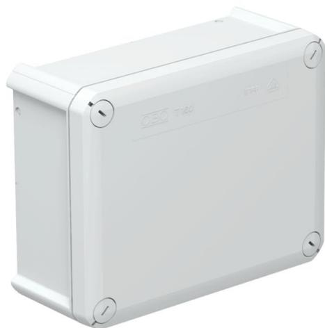
Kabelabzweigkasten zum Verbinden von Kabeln und Leitungen im Innenbereich und geschützten Außenbereichen. Rechteckige Form ohne Einführungen. Geeignet für die Wand-/ Deckenmontage und die Montage auf Montageblechen. Mit der Möglichkeit zur Innenbefestigung und Montage über die Eckdome. Deckel mit Schnellverschluss, plombierbar. Hergestellt aus halogenfreien und UV-stabilisierten Materialien.
