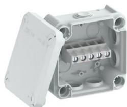
Kabelabzweigkasten mit Klemmleiste zum Verbinden von Kabeln und Leitungen im Innenbereich und geschützten Außenbereichen. Quadratische Form mit Einsteckdichtungen an den Seiten und Ausschlageinführungen im Boden. Geeignet für die Wand-/ Deckenmontage und die Montage auf Montageblechen. Mit der Möglichkeit zur Innenbefestigung und Montage über die Eckdome. Deckel mit Schnellverschluss, plombierbar. Hergestellt aus halogenfreien und UV-stabilisierten Materialien.
