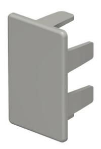
Endstück zum Verschließen der WDK-Kanäle. Die Endstücke werden auf den WDK-Kanal aufgedrückt und durch eine Federwirkung gehalten.
