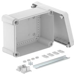
Kabelabzweigkasten mit Hutprofilschiene zum Verbinden von Kabeln und Leitungen im Innen- und Außenbereich. Rechteckige Form ohne Einführungen. Geeignet für die Wand-/ Deckenmontage mit der Möglichkeit zur Außenbefestigung, Innenbefestigung oder Montage über die Eckdome. Besonders schlagfest mit IK09. Deckel mit Schnellverschluss, plombierbar. Hergestellt aus halogenfreien und UV-beständigen Materialien.
