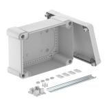
Kabelabzweigkasten mit Hutprofilschiene zum Verbinden von Kabeln und Leitungen im Innen- und Außenbereich. Rechteckige Form ohne Einführungen. Geeignet für die Wand-/ Deckenmontage mit der Möglichkeit zur Außenbefestigung, Innenbefestigung oder Montage über die Eckdome. Besonders schlagfest mit IK08. Deckel mit Schnellverschluss, plombierbar. Hergestellt aus halogenfreien und UV-resistenten Materialien.
