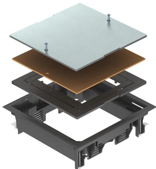
Zugdoseneinsatz zum Blindverschluss einer quadratischen Montageöffnung der Nenngröße 4, Einsatz in Kanalsystemen und Systemböden im Innenbereich. Bodenbelagausparung bei Lieferung auf 5 mm eingestellt, bei Bedarf auch einstellbar auf 3, 8 oder 10 mm.
