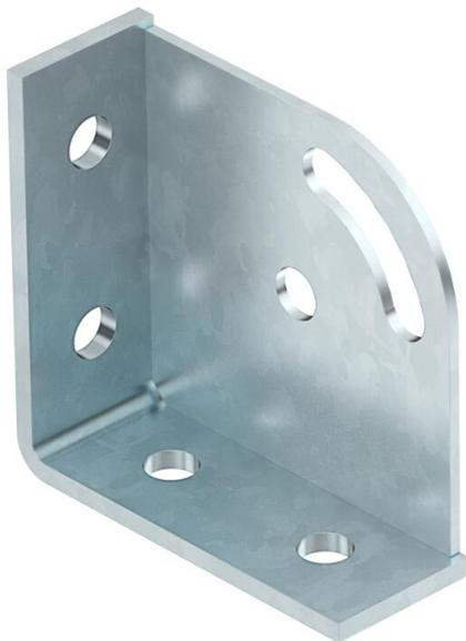
Verstärkter Montagewinkel mit 6 Löchern zur Verbindung von Profilschienen 41 x 41 mm und 41 x 21 mm im Winkel von 90°. Zusätzliche Befestigungsmöglichkeit einer Strebe im Winkel von 45° mit einer Verstellmöglichkeit von +/- 30°. Für Winkel von 15° bis 75° einsetzbar.
