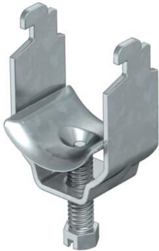
Passend zu allen C-Proflschienen mit 11 - 12 mm Schlitzweite; mindestens 6,5 mm lichter Innenhöhe und mindestens 18,5 mm lichter Innenbreite; Metallwannen haben allseitig stark gerundete Kanten, sodass keine Kabelschädigung zu befürchten ist. Ausführung mit Anschweiß- und/oder Kontermutter für Einsatz unter erschwerten Bedingungen sowie für Rüttelsicherheit auf Anfrage!
