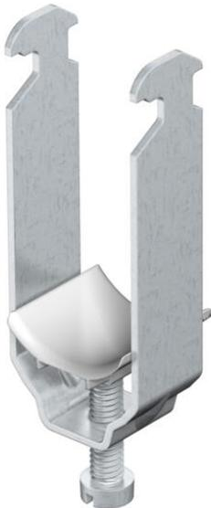
Passend zu allen C-Profilshienen mit 16 - 17 mm Schlitzweite; Shelle und Schraube aus Aluminium ALMg 3, Druckwanne aus Polypropylen, halogenfrei, lichtgrau RAL 7035.
