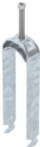
Bügelschelle mit Hammerkopf-Fuß, Metalldruckwanne mit gerundeten Kanten für Kabelschutz. Zur vertikalen und horizontalen Montage von 3 Einzelkabeln an C-Profilschiene. Für Schlitzweite 16 - 17 mm. Mit 1-gängiger Schraube an Druckwanne, universeller Sechskant-Schraubenkopf SW10, mit Schlitz und Kreuzschlitz. Geeignet für Montage im Innen- und Außenbereich. Mehrere Kabel sollten durch Doppelwannen getrennt werden. Der Einsatz einer Gegenwanne wird empfohlen.
