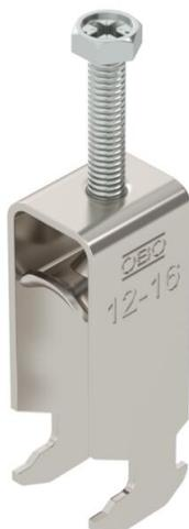
Bügelshelle mit Hammerkopf-Fuß, Metalldruckwanne mit gerundeten Kanten für Kabelschutz. Zur vertikalen und horizontalen Montage von 2 Einzelkabeln an C-Profilshiene. Für Schlitzweite 16 - 17 mm. Mit 1-gängiger Schraube an Druckwanne, universeller Sechskant-Schraubenkopf SW10, mit Schlitz und Kreuzschlitz. Geeignet für Montage im Innen- und Außenbereich. Mehrere Kabel sollten durch Doppelwannen getrennt werden. Der Einsatz einer Gegenwanne wird empfohlen.
