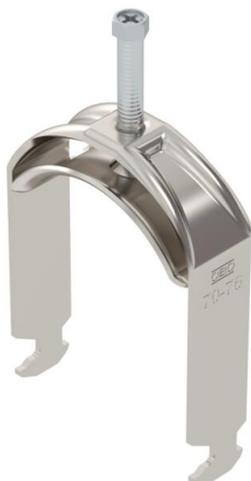
Bügelschelle mit Hammerkopf-Fuß, Metalldruckwanne mit gerundeten Kanten für Kabelschutz. Zur vertikalen und horizontalen Montage von 1 Einzelkabel an C-Profileschiene. Für Schlitzweite 16 - 17 mm. Mit 1-gängiger Schraube an Druckwanne, universeller Sechskant-Schraubenkopf SW10, mit Schlitz und Kreuzschlitz. Geeignet für Montage im Innen- und Außenbereich. Der Einsatz einer Gegenwanne wird empfohlen.
