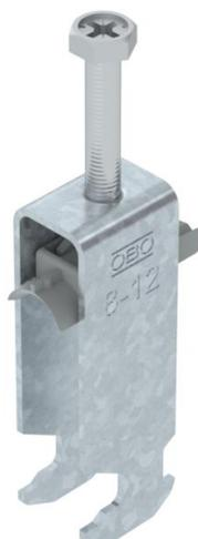
Bügelschelle mit Hammerkopf-Fuß, Kunststoffdruckwanne aus Polypropylen. Zur vertikalen und horizontalen Montage von 3 Einzelkabeln an C-Profilschiene. Für Schlitzweite 16 - 17 mm. Mit 1-gängiger Schraube an Druckwanne, universeller Sechskant-Schraubenkopf SW10, mit Schlitz und Kreuzschlitz. Geeignet für Montage im Innen- und Außenbereich. Mehrere Kabel sollten durch Doppelwannen getrennt werden. Der Einsatz einer Gegenwanne wird empfohlen.
