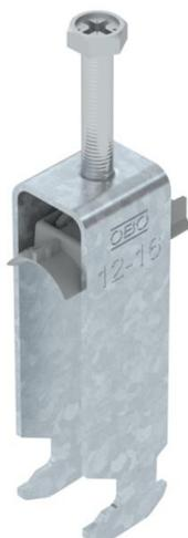
Bügel­schelle mit Hammerkopf-Fuß, Kunststoffdruckwanne aus Polypropylen. Zur vertikalen und horizontalen Montage von 3 Einzelkabeln an C-Profileschiene. Für Schlitzweite 16 - 17 mm. Mit 1-gängiger Schraube an Druckwanne, universeller Sechskant-Schraubenkopf SW10, mit Schlitz und Kreuzschlitz. Geeignet für Montage im Innen- und Außenbereich. Mehrere Kabel sollten durch Doppelwannen getrennt werden. Der Einsatz einer Gegenwanne wird empfohlen.
