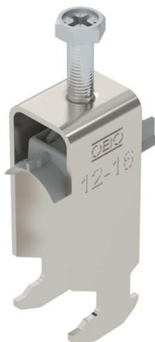
Bügelschelle mit Hammerkopf-Fuß, Kunststoffdruckwanne aus Polypropylen. Zur vertikalen und horizontalen Montage von 2 Einzelkabeln an C-Profileschiene. Für Schlitzweite 16 - 17 mm. Mit 1-gängiger Schraube an Druckwanne, universeller Sechskant-Schraubenkopf SW10, mit Schlitz und Kreuzschlitz. Geeignet für Montage im Innen- und Außenbereich. Mehrere Kabel sollten durch Doppelwannen getrennt werden. Der Einsatz einer Gegenwanne wird empfohlen.
