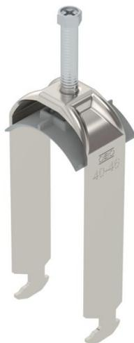
Bügelschelle mit Hammerkopf-Fuß, Kunststoffdruckwanne aus Polypropylen. Zur vertikalen und horizontalen Montage von 2 Einzelkabeln an C-Profiltschiene. Für Schlitzweite 16 - 17 mm. Mit 1-gängiger Schraube an Druckwanne, universeller Sechskant-Schraubenkopf SW10, mit Schlitz und Kreuzschlitz. Geeignet für Montage im Innen- und Außenbereich. Mehrere Kabel sollten durch Doppelwannen getrennt werden. Der Einsatz einer Gegenwanne wird empfohlen.
