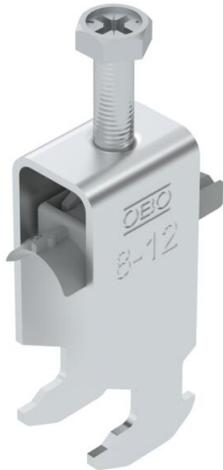
Bügel­schelle mit Hammerkopf-Fuß, Kunststoffdruckwanne aus Polypropylen. Zur vertikalen und horizontalen Montage von 2 Einzelkabeln an C-Profil­schiene. Für Schlitzweite 16 - 17 mm. Mit 1-gängiger Schraube an Druckwanne, universeller Sechskant-Schraubenkopf SW10, mit Schlitz und Kreuzschlitz. Geeignet für Montage im Innen- und Außenbereich. Mehrere Kabel sollten durch Doppelwan­nen getrennt werden. Der Einsatz einer Gegenwanne wird empfohlen.
