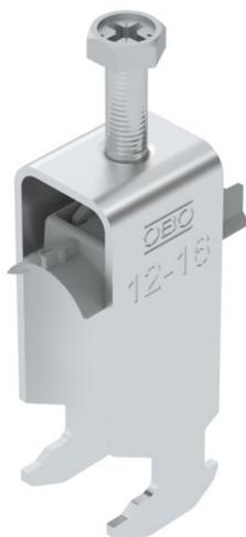
Bügel­schelle mit Hammerkopf-Fuß, Kunststoffdruckwanne aus Polypropylen. Zur vertikalen und horizontalen Montage von 2 Einzelkabeln an C-Profil­schiene. Für Schlitzweite 16 - 17 mm. Mit 1-gängiger Schraube an Druckwanne, universeller Sechskant-Schraubenkopf SW10, mit Schlitz und Kreuzschlitz. Geeignet für Montage im Innen- und Außenbereich. Mehrere Kabel sollten durch Doppelwan­nen getrennt werden. Der Einsatz einer Gegenwanne wird empfohlen.
