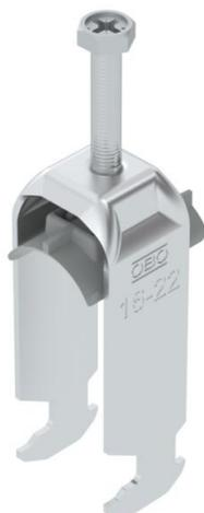
Bügelshelle mit Hammerkopf-Fuß, Kunststoffdruckwanne aus Polypropylen. Zur vertikalen und horizontalen Montage von 2 Einzelkabeln an C-Profilshiene. Für Schlitzweite 16 - 17 mm. Mit 1-gängiger Schraube an Druckwanne, universeller Sechskant-Schraubenkopf SW10, mit Schlitz und Kreuzschlitz. Geeignet für Montage im Innen- und Außenbereich. Mehrere Kabel sollten durch Doppelwannen getrennt werden. Der Einsatz einer Gegenwanne wird empfohlen.
