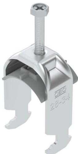
Bügelschelle mit Hammerkopf-Fuß, Kunststoffdruckwanne aus Polypropylen. Zur vertikalen und horizontalen Montage von 1 Einzelkabel an C-Profileschiene. Für Schlitzweite 16 - 17 mm. Mit 1-gängiger Schraube an Druckwanne, universeller Sechskant-Schraubenkopf SW10, mit Schlitz und Kreuzschlitz. Geeignet für Montage im Innen- und Außenbereich. Der Einsatz einer Gegenwanne wird empfohlen.
