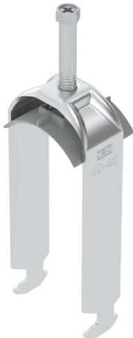
Bügelschelle mit Hammerkopf-Fuß, Kunststoffdruckwanne aus Polypropylen. Zur vertikalen und horizontalen Montage von 2 Einzelkabeln an C-Profilschiene. Für Schlitzweite 16 - 17 mm. Mit 1-gängiger Schraube an Druckwanne, universeller Sechskant-Schraubenkopf SW10, mit Schlitz und Kreuzschlitz. Geeignet für Montage im Innen- und Außenbereich. Mehrere Kabel sollten durch Doppelwanne getrennt werden. Der Einsatz einer Gegenwanne wird empfohlen.
