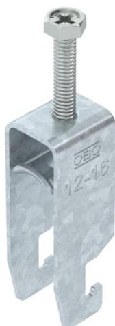
Bügel­schelle mit U-Fuß, Metall­druckwanne mit gerundeten Kanten für Kabel­schutz. Zur vertikalen und horizontalen Montage von 2 Einzelkabeln an C-Profil­schiene. Für Schlitzweite 18 - 22 mm. Mit 1-gängiger Schraube an Druckwanne, universeller Sechskant-Schraubenkopf SW10, mit Schlitz und Kreuzschlitz. Geeignet für Montage im Innen- und Außenbereich. Mehrere Kabel sollten durch Doppelwannen getrennt werden. Der Einsatz einer Gegenwanne wird empfohlen.
