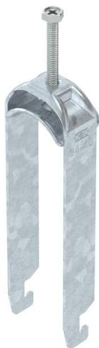
Bügelshelle mit U-Fuß, Metalldruckwanne mit gerundeten Kanten für Kabelschutz. Zur vertikalen und horizontalen Montage von 3 Einzelkabeln an C-Profilshiene. Für Schlitzweite 18 - 22 mm. Mit 1-gängiger Schraube an Druckwanne, universeller Sechskant-Schraubenkopf SW10, mit Schlitz und Kreuzschlitz. Geeignet für Montage im Innen- und Außenbereich. Mehrere Kabel sollten durch Doppelwannen getrennt werden. Der Einsatz einer Gegenwanne wird empfohlen.
