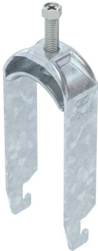
Bügelshelle mit U-Fuß, Metalldruckwanne mit gerundeten Kanten für Kabelschutz. Zur vertikalen und horizontalen Montage von 2 Einzelkabeln an C-Profil-schiene. Für Schlitzweite 18 - 22 mm. Mit 1-gängiger Schraube an Druckwanne, universeller Sechskant-Schraubenkopf SW10, mit Schlitz und Kreuzschlitz. Geeignet für Montage im Innen- und Außenbereich. Mehrere Kabel sollten durch Doppelwannen getrennt werden. Der Einsatz einer Gegenwanne wird empfohlen.
