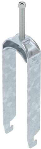
Bügelshelle mit U-Fuß, Metalldruckwanne mit gerundeten Kanten für Kabelschutz. Zur vertikalen und horizontalen Montage von 3 Einzelkabeln an C-Profilshiene. Für Schlitzweite 18 - 22 mm. Mit 1-gängiger Schraube an Druckwanne, universeller Sechskant-Schraubenkopf SW10, mit Schlitz und Kreuzschlitz. Geeignet für Montage im Innen- und Außenbereich. Mehrere Kabel sollten durch Doppelwannen getrennt werden. Der Einsatz einer Gegenwanne wird empfohlen.
