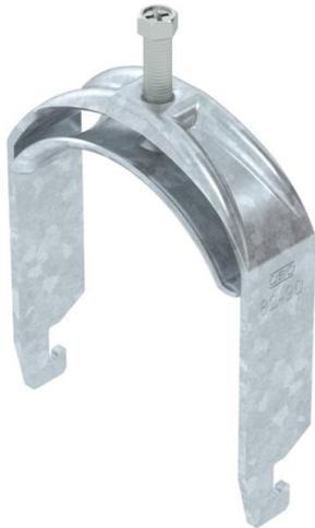
Bügelschelle mit U-Fuß, Metalldruckwanne mit gerundeten Kanten für Kabelschutz. Zur vertikalen und horizontalen Montage von 1 Einzelkabel an C-Profil-schiene. Für Schlitzweite 18 - 22 mm. Mit 1-gängiger Schraube an Druckwanne, universeller Sechskant-Schraubenkopf SW10, mit Schlitz und Kreuzschlitz. Geeignet für Montage im Innen- und Außenbereich. Der Einsatz einer Gegenwanne wird empfohlen.
