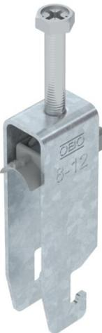
Bügelschelle mit U-Fuß, Kunststoffdruckwanne aus Polypropylen. Zur vertikalen und horizontalen Montage von 3 Einzelkabeln an C-Profilschiene. Für Schlitzweite 18 mm oder 22 mm. Mit 1-gängiger Schraube an Druckwanne, universeller Sechskant-Schraubenkopf SW10, mit Schlitz und Kreuzschlitz. Geeignet für Montage im Innen- und Außenbereich. Mehrere Kabel sollten durch Doppelwangen getrennt werden. Der Einsatz einer Gegenwanne wird empfohlen.
