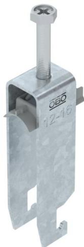
Bügelschelle mit U-Fuß, Kunststoffdruckwanne aus Polypropylen. Zur vertikalen und horizontalen Montage von 3 Einzelkabeln an C-Profilschiene. Für Schlitzweite 18 mm oder 22 mm. Mit 1-gängiger Schraube an Druckwanne, universeller Sechskant-Schraubenkopf SW10, mit Schlitz und Kreuzschlitz. Geeignet für Montage im Innen- und Außenbereich. Mehrere Kabel sollten durch Doppelwannen getrennt werden. Der Einsatz einer Gegenwanne wird empfohlen.
