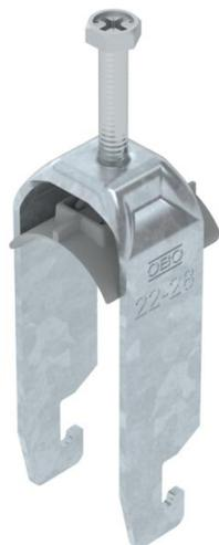
Bügelschelle mit U-Fuß, Kunststoffdruckwanne aus Polypropylen. Zur vertikalen und horizontalen Montage von 2 Einzelkabeln an C-Profilschiene. Für Schlitzweite 18 - 22 mm. Mit 1-gängiger Schraube an Druckwanne, universeller Sechskant-Schraubenkopf SW10, mit Schlitz und Kreuzschlitz. Geeignet für Montage im Innen- und Außenbereich. Mehrere Kabel sollten durch Doppelwannen getrennt werden. Der Einsatz einer Gegenwanne wird empfohlen.
