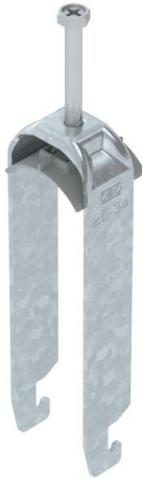
Bügelschelle mit U-Fuß, Kunststoffdruckwanne aus Polypropylen. Zur vertikalen und horizontalen Montage von 3 Einzelkabeln an C-Profilschiene. Für Schlitzweite 18 mm oder 22 mm. Mit 1-gängiger Schraube an Druckwanne, universeller Sechskant-Schraubenkopf SW10, mit Schlitz und Kreuzschlitz. Geeignet für Montage im Innen- und Außenbereich. Mehrere Kabel sollten durch Doppelwannen getrennt werden. Der Einsatz einer Gegenwanne wird empfohlen.
