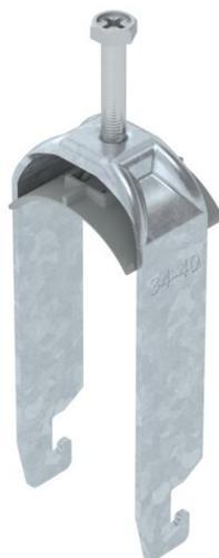
Bügelschelle mit U-Fuß, Kunststoffdruckwanne aus Polypropylen. Zur vertikalen und horizontalen Montage von 2 Einzelkabeln an C-Profilschiene. Für Schlitzweite 18 - 22 mm. Mit 1-gängiger Schraube an Druckwanne, universeller Sechskant-Schraubenkopf SW10, mit Schlitz und Kreuzschlitz. Geeignet für Montage im Innen- und Außenbereich. Mehrere Kabel sollten durch Doppelwannen getrennt werden. Der Einsatz einer Gegenwanne wird empfohlen.
