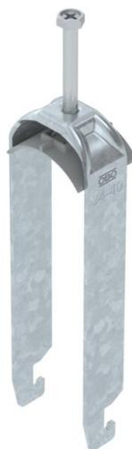
Bügel­schelle mit U-Fuß, Kunststoffdruckwanne aus Polypropylen. Zur vertikalen und horizontalen Montage von 3 Einzelkabeln an C-Profilschiene. Für Schlitzweite 18 mm oder 22 mm. Mit 1-gängiger Schraube an Druckwanne, universeller Sechskant-Schraubenkopf SW10, mit Schlitz und Kreuzschlitz. Geeignet für Montage im Innen- und Außenbereich. Mehrere Kabel sollten durch Doppelwannen getrennt werden. Der Einsatz einer Gegenwanne wird empfohlen.
