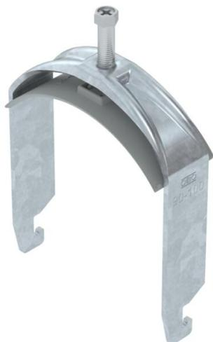
Bügelschelle mit U-Fuß, Kunststoffdruckwanne aus Polypropylen. Zur vertikalen und horizontalen Montage von 1 Einzelkabel an C-Profilschiene. Für Schlitzweite 18 - 22 mm. Mit 1-gängiger Schraube an Druckwanne, universeller Sechskant-Schraubenkopf SW10, mit Schlitz und Kreuzschlitz. Geeignet für Montage im Innen- und Außenbereich. Der Einsatz einer Gegenwanne wird empfohlen.
