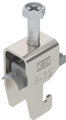
Bügel­schelle mit U-Fuß, Kunststoffdruckwanne aus Polypropylen. Zur vertikalen und horizontalen Montage von 1 Einzelkabel an C-Profileschiene. Für Schlitzweite 18 - 22 mm. Mit 1-gängiger Schraube an Druckwanne, universeller Sechskant-Schraubenkopf SW10, mit Schlitz und Kreuzschlitz. Geeignet für Montage im Innen- und Außenbereich. Der Einsatz einer Gegenwanne wird empfohlen.
