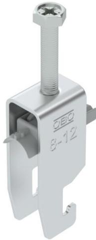
Bügelshelle mit U-Fuß, Kunststoffdruckwanne aus Polypropylen. Zur vertikalen und horizontalen Montage von 2 Einzelkabeln an C-Profilshiene. Für Schlitzweite 18 - 22 mm. Mit 1-gängiger Schraube an Druckwanne, universeller Sechskant-Schraubenkopf SW10, mit Schlitz und Kreuzschlitz. Geeignet für Montage im Innen- und Außenbereich. Mehrere Kabel sollten durch Doppelwannen getrennt werden. Der Einsatz einer Gegenwanne wird empfohlen.
