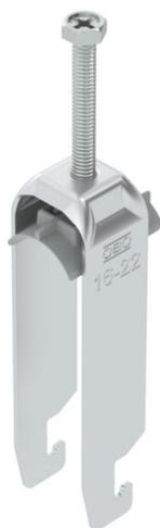
Bügelshelle mit U-Fuß, Kunststoffdruckwanne aus Polypropylen. Zur vertikalen und horizontalen Montage von 3 Einzelkabeln an C-Profilshiene. Für Schlitzweite 18 - 22 mm. Mit 1-gängiger Schraube an Druckwanne, universeller Sechskant-Schraubenkopf SW10, mit Schlitz und Kreuzschlitz. Geeignet für Montage im Innen- und Außenbereich. Mehrere Kabel sollten durch Doppelwannen getrennt werden. Der Einsatz einer Gegenwanne wird empfohlen.
