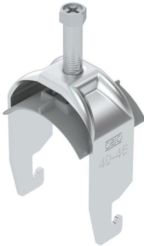
Bügelschelle mit U-Fuß, Kunststoffdruckwanne aus Polypropylen. Zur vertikalen und horizontalen Montage von 1 Einzelkabel an C-Profilschiene. Für Schlitzweite 18 - 22 mm. Mit 1-gängiger Schraube an Druckwanne, universeller Sechskant-Schraubenkopf SW10, mit Schlitz und Kreuzschlitz. Geeignet für Montage im Innen- und Außenbereich. Der Einsatz einer Gegenwanne wird empfohlen.
