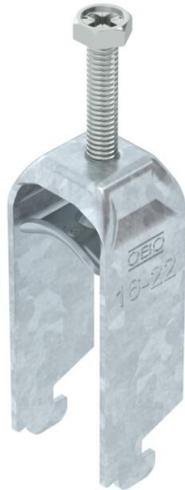
Bügelshelle mit N-Fuß, Metalldruckwanne mit gerundeten Kanten für Kabelschutz. Zur vertikalen und horizontalen Montage von 2 Einzelkabeln an C-Profil-schiene. Für Schlitzweite 11 - 12 mm. Mit 1-gängiger Schraube an Druckwanne, universeller Sechskant-Schraubenkopf SW10, mit Schlitz und Kreuzschlitz. Geeignet für Montage im Innen- und Außenbereich. Mehrere Kabel sollten durch Doppelwannen getrennt werden. Der Einsatz einer Gegenwanne wird empfohlen.
