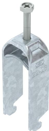
Bügel­schelle mit N-Fuß, Metall­druckwanne mit gerundeten Kanten für Kabel­schutz. Zur vertikalen und horizontalen Montage von 2 Einzelkabeln an C-Profil­schiene. Für Schlitzweite 11 - 12 mm. Mit 1-gängiger Schraube an Druckwanne, universeller Sechskant-Schraubenkopf SW10, mit Schlitz und Kreuzschlitz. Ge­eignet für Montage im Innen- und Außenbereich. Mehrere Kabel sollten durch Doppelwannen getrennt werden. Der Einsatz einer Gegenwanne wird empfohlen.
