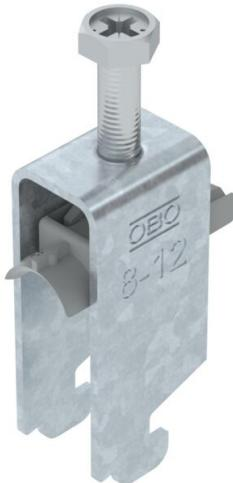
Bügelschelle mit N-Fuß, Kunststoffdruckwanne aus Polypropylen. Zur vertikalen und horizontalen Montage von 2 Einzelkabeln an C-Profilschiene. Für Schlitzweite 11 - 12 mm. Mit 1-gängiger Schraube an Druckwanne, universeller Sechskantschraubenkopf SW10, mit Schlitz und Kreuzschlitz. Geeignet für Montage im Innen- und Außenbereich. Mehrere Kabel sollten durch Doppelwannen getrennt werden. Der Einsatz einer Gegenwanne wird empfohlen.
