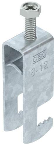
Bügelschelle mit F-Fuß, Metalldruckwanne mit gerundeten Kanten für Kabelschutz. Zur vertikalen und horizontalen Montage von 2 Einzelkabeln an Flacheisen. Mit 1-gängiger Schraube an Druckwanne, universeller Sechskant-Schraubenkopf SW10, mit Schlitz und Kreuzschlitz. Geeignet für Montage im Innen- und Außenbereich. Mehrere Kabel sollten durch Doppelwannen getrennt werden. Der Einsatz einer Gegenwanne wird empfohlen.
