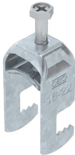
Bügelschelle mit F-Fuß, Metalldruckwanne mit gerundeten Kanten für Kabelschutz. Zur vertikalen und horizontalen Montage von 1 Einzelkabel an Flacheisen. Mit 1-gängiger Schraube an Druckwanne, universeller Sechskant-Schraubenkopf SW10, mit Schlitz und Kreuzschlitz. Geeignet für Montage im Innen- und Außenbereich. Der Einsatz einer Gegenwanne wird empfohlen.
