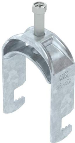
Bügelschelle mit F-Fuß, Metalldruckwanne mit gerundeten Kanten für Kabelschutz. Zur vertikalen und horizontalen Montage von 2 Einzelkabeln an Flacheisen. Mit 1-gängiger Schraube an Druckwanne, universeller Sechskant-Schraubenkopf SW10, mit Schlitz und Kreuzschlitz. Geeignet für Montage im Innen- und Außenbereich. Mehrere Kabel sollten durch Doppelwannen getrennt werden. Der Einsatz einer Gegenwanne wird empfohlen.
